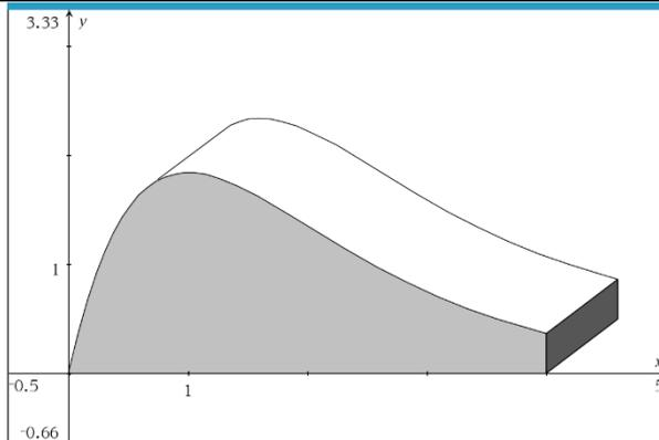
Das Profil dieser Rutsche wird in Metern gemessen und kann durch die Funktion  $F$  modelliert werden, gegeben durch  $F(x) = (ax - b)e^{-x}$ , für  $1 \leq x \leq 4$ , wobei  $a$  und  $b$  zwei Parameter sind. Die Funktion  $F$  wurde unten gezeichnet.
